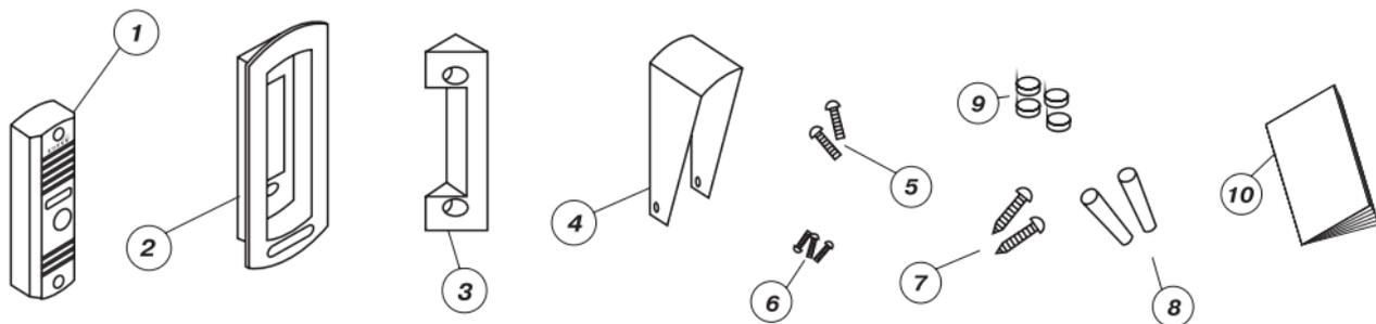
Вызывная видеопанель предназначена для работы в составе видеодомофона и обеспечивает наблюдение пространства перед входной дверью и речевую связь с посетителем.
