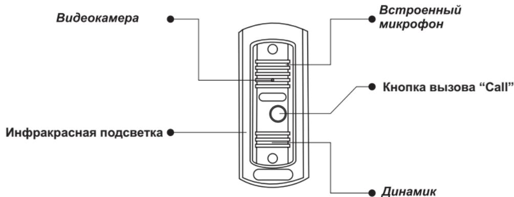
Установите вызывную видеопанель в (на) стену, наличник или неподвижную створку двери, как показано на рисунке. Установку нужно произвести таким образом, чтобы отверстие камеры вызывной видеопанели находилось на уровне глаз человека среднего роста.
