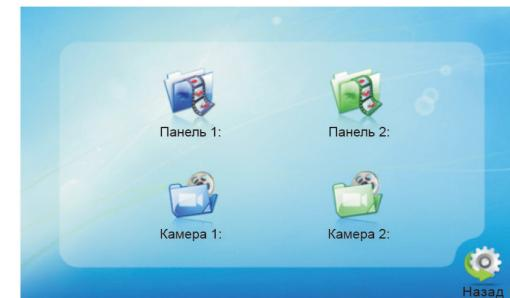
В открывшемся окне собраны параметры, необходимые при настройке качества изображения, поступающего с вызываемых панелей и камер Панель 1 / Панель 2 / Камера 1 / Камера 2. Прокручивая клавишу "\*" вверх-вниз, установите курсор на одну из иконок "Панель1", "Панель2", "Камера1" или "Камера 2" и нажмите "\*" для перехода в соответствующий раздел, чтобы отрегулировать яркость, контраст и насыщенность в соответствии с фактическими условиями окружающей среды.
