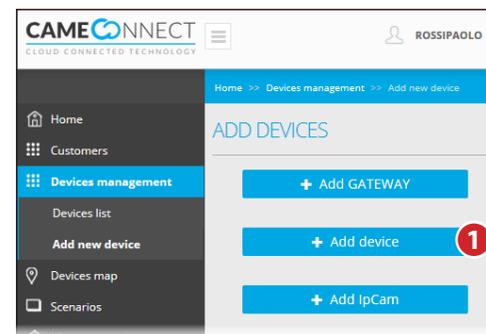
**1** После регистрации хотя бы одного шлюза можно добавить контролируемое устройство (автоматическую систему или плату ввода-вывода).
